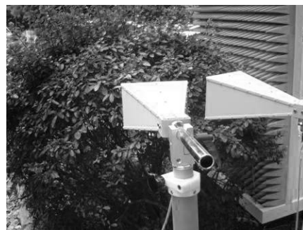
図 2 低木からの散乱波形測定風景
