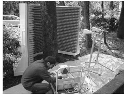
図 1 木幹からの散乱波形測定風景
